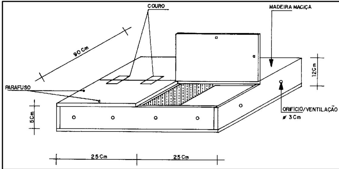
Figura 9.5 - Caixa para Transporte de Ofídios - Modelo Butantã
