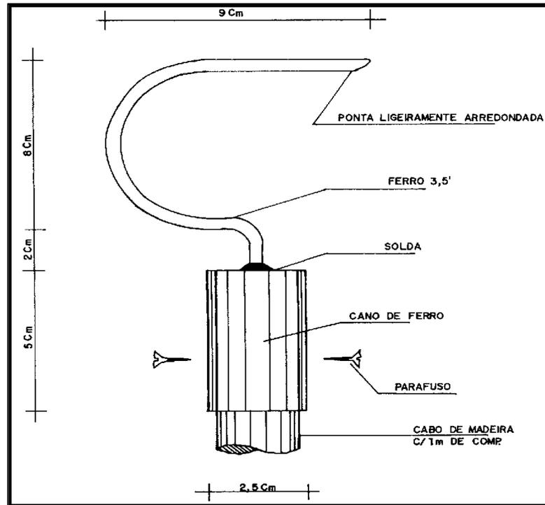
Figura 9.3 - Gancho Modelo Butantã, Tipo Curvo para Captura de Serpentes
